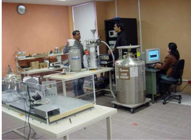
Figura 8.1: Estudiantes del INAOE en el Laboratorio de Instrumentación Milimétrica. Se está desarrollando un sistema de detección basado en un bolómetro compuesto, para medir el brillo del cielo de la Sierra Negra en ondas milimétricas
