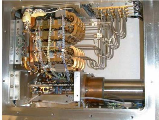
Figura 7.7: Detalles del interior del criostato de SEQUOIA. La altura entre la parte inferior y la superior es de 25 cm aproximadamente.
